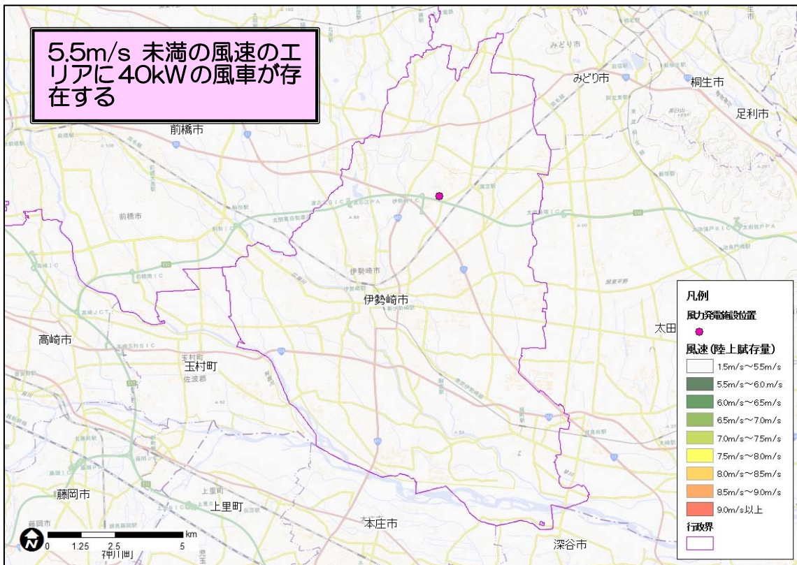
図 5.1-18 風速 5.5m/s 未満の範囲に発電施設がある例（伊勢崎市）
