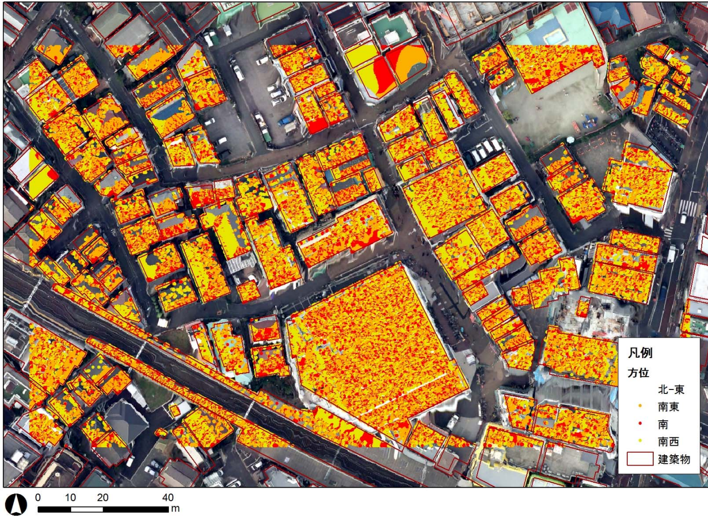
図 6.4-19 SfM によって固定資産税調査用空中写真から生成した DSM における傾斜方向の再現
