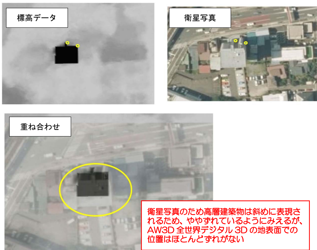
図 6.4-14 高層建築物における航空写真と AW3D 全世界デジタル 3D の誤差例
