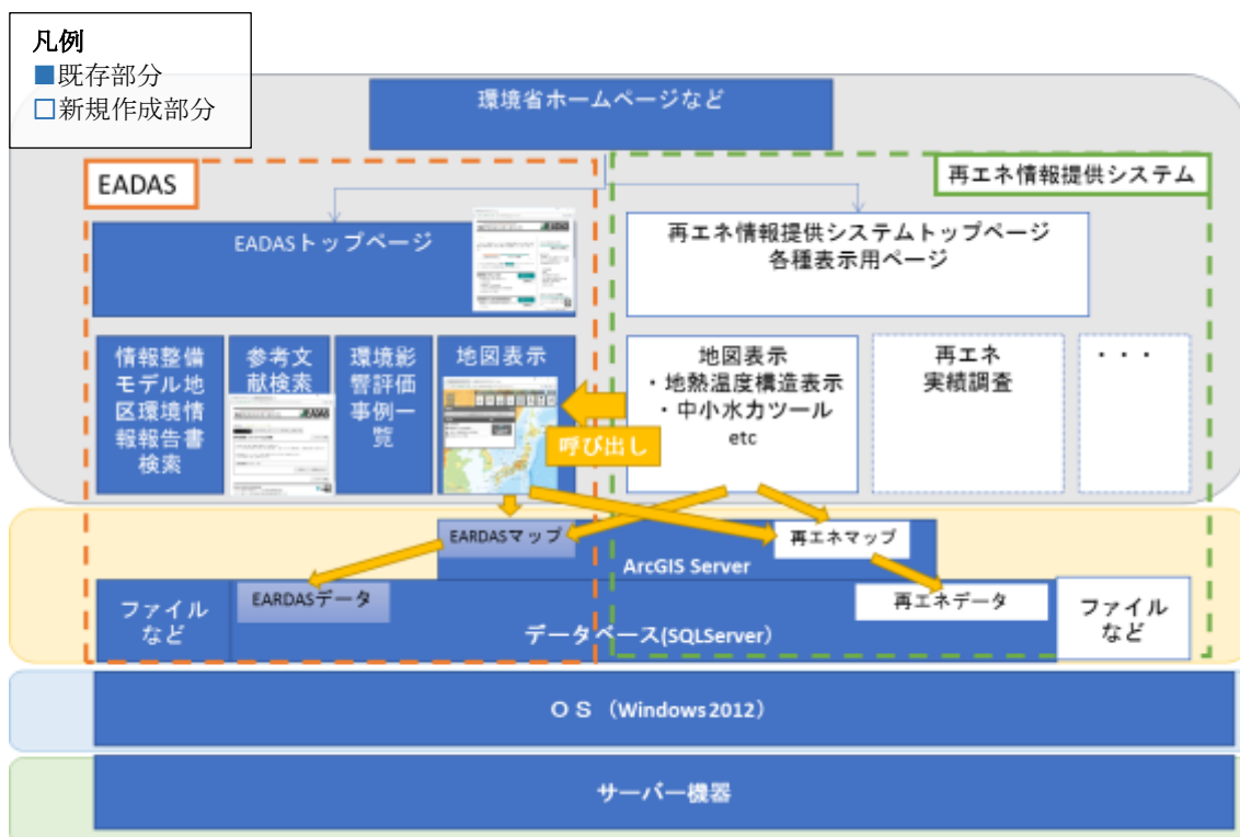
図 2.1-3(2) EADAS 基盤を利用した再エネ情報提供システムの搭載
