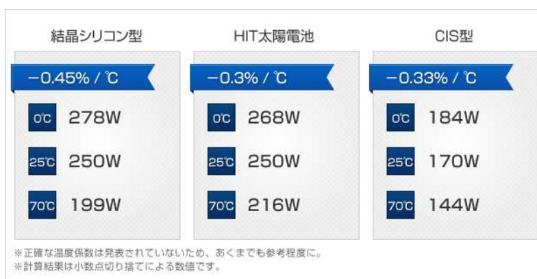
図 5.1-10 太陽光発電のソーラーパネルの素材別の出力変化率
