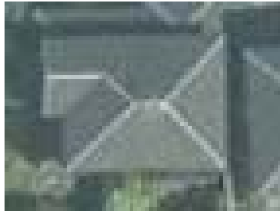
航空画像に現れるモスキート・ノイズ (屋根上にPVなし)
